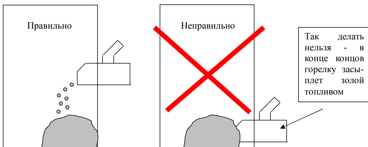
Рис. 6 - Принцип установки горелки в тепловой агрегат
