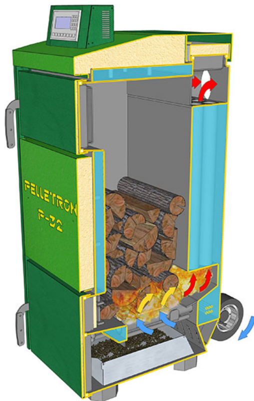
Рис. 2 - Принцип действия котла Profi
