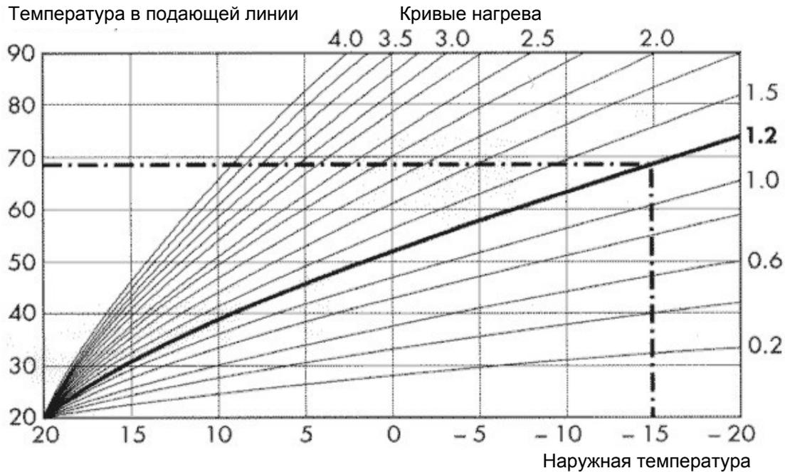
На диаграмме выбрана кривая тип „НК1.2“. Это означает, что при необходимой комнатной температуре 20°C и наружной температуре -15°C температура в подающей линии должна составлять около 70°C.
