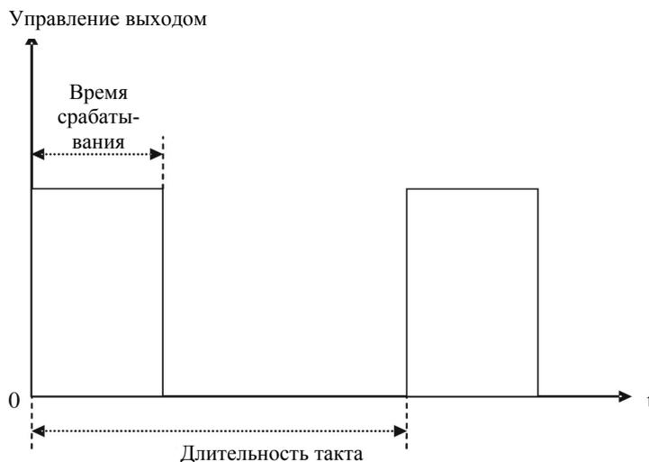
$$\text{Время срабатывания исполнительного элемента} = \frac{\text{Общее время работы}}{\text{Срабатывание ступеней}}$$
