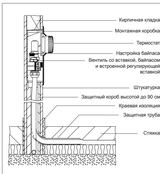
Пример установки „Unibox E BV“ в стене
