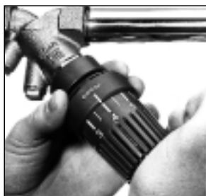
Рис. 9: Нажать рукой на маховик с усилием так, чтобы он вошел в держатель. Область настройки термостата теперь ограничена. Можно установить значения настройки только между „4” и „6” (ок. 40 °С– 60 °С).
