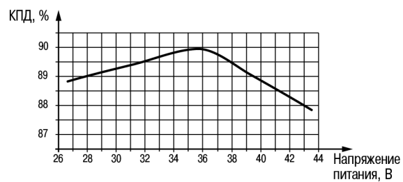
Рисунок 6.3 – График зависимости КПД от напряжения питания (от РСР ЖД-станций)
