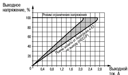
Рисунок 3 - График зависимости выходного напряжения от выходного тока (НИССУР)
