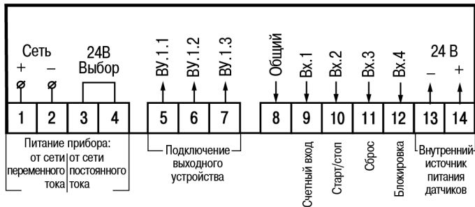
Рисунок 5.1 – Назначение контактов клеммника
