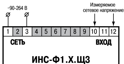
Рисунок 6 – Назначение клеммника прибора модификации ШЗ
