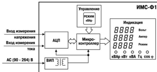
Рисунок 6.1 – Функциональная схема прибора
