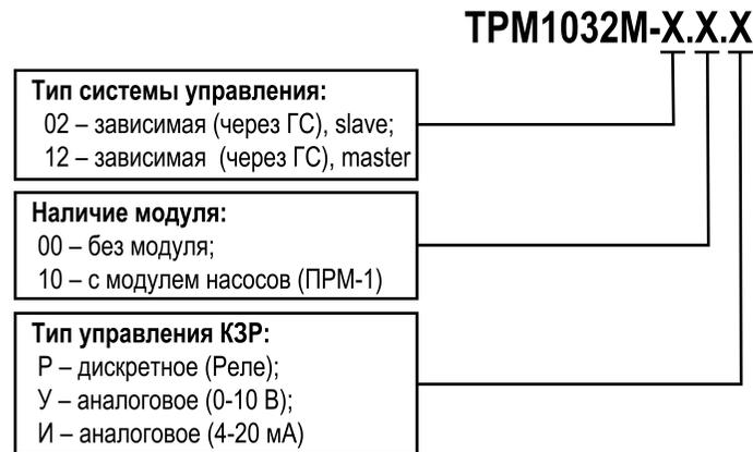
Модуль расширения ПРМ-1 для управления вторыми насосами контуров входит в комплект поставки к модификации ТРМ1032М, которая поддерживает с ним работу. Если необходимо, то модуль расширения можно приобрести отдельно. Совместимая модификация модулей: ПРМ-220.1.
