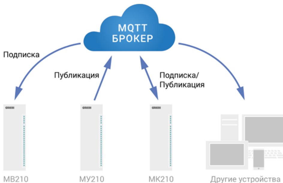
Рисунок 6.2 – Структурная схема обмена по протоколу MQTT
