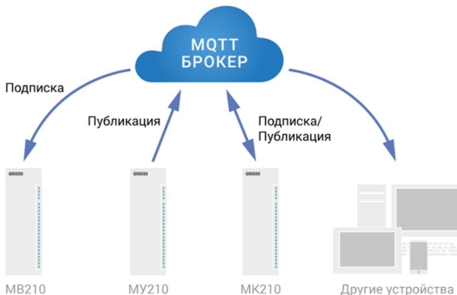
Рисунок 6.2 – Структурная схема обмена по протоколу MQTT
