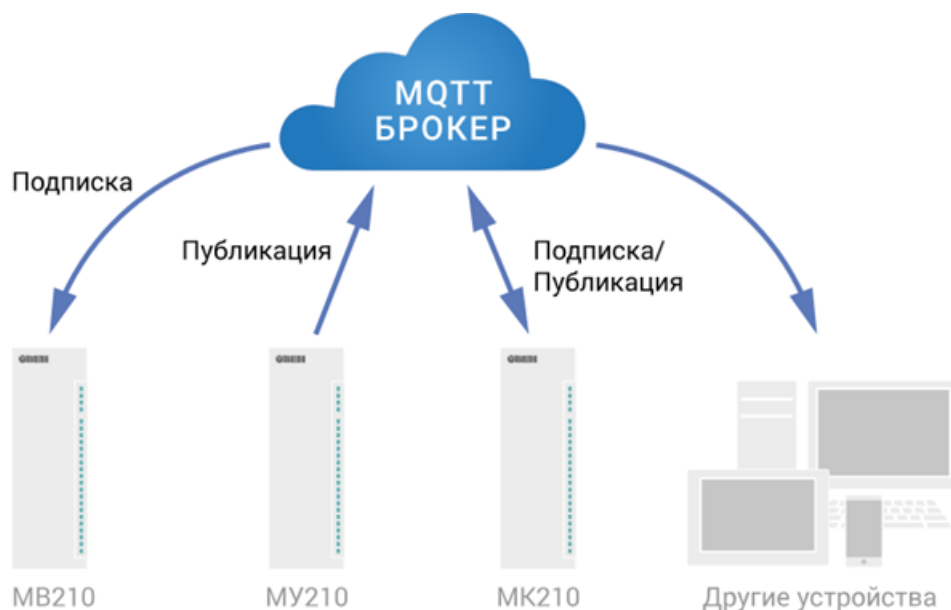
Рисунок 6.2 – Структурная схема обмена по протоколу MQTT
