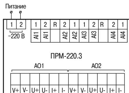
Рисунок 5.3 – Назначение контактов клеммника прибора с питанием 230 В
