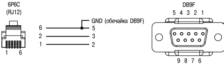
Рисунок В.2 – Схема кабеля KC2
