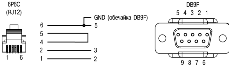
Рисунок В.1 – Схема кабеля программирования KC1, входящего в комплект поставки
