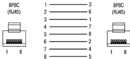
Рисунок В.5 – Кабель Ethernet crossover
