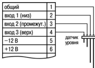
Рисунок 5.3 – Схема подключения кондуктометрических датчиков уровня
