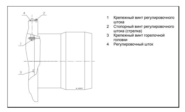
**Вним!** Если место кольца относительно диффузора меняется, также скорость и расход воздуха меняются. Проверьте результат сжигания анализом дымовых газов и подрегулируйте подачу воздуха.
