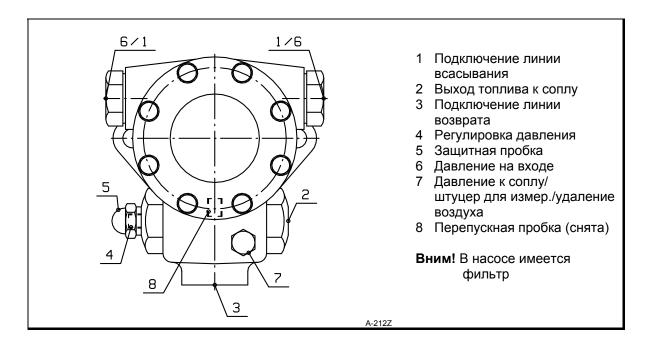
Давление топлива подходящего от насосного центра должно быть на входе в насос 1 - 3,5 бар. Максимальная температура мазута на входе в насос 120 °C.
