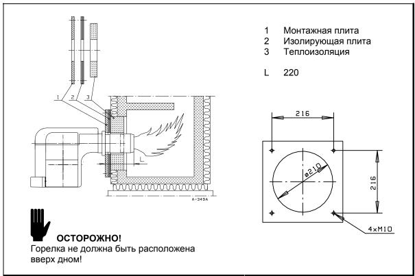
Для крепления горелки в монтажную плиту необходимо просверлить 4 отверстия с резьбой М10 согласно рисунку.
