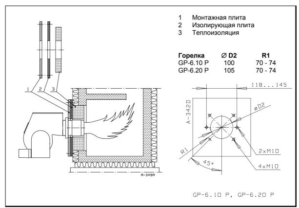
Для крепления горелки в монтажную плиту необходимо просверлить 2 или 4 отверстия с резьбой М10 согласно рисунку.
