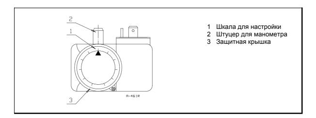
Реле минимального давления газа настраивают на 20 — 40 % ниже, чем давление на входе в горелку при работе горелки на полной мощности. Если реле давления при пуске горелки моментально остановит горелку, необходимо подстроить реле на более низкое давление. Для подстройки откройте защитную крышку реле и поверните диск. После настройки установите защитную крышку обратно на место.
