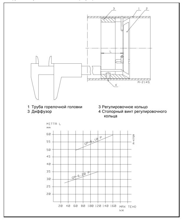
**Вним.!** Если положение регулировочного кольца относительно диффузора изменяется, меняются также скорость прохода и объем воздуха. Проверьте качество сжигания по анализу дымовых газов и, при надобности, подрегулируйте расход воздуха.
