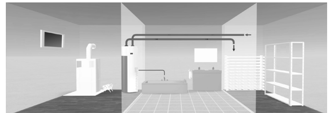
Kühlung des Vorratsraumes
