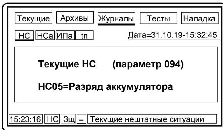
Рисунок 5.7 – Вывод на дисплей информации о действующих НС
