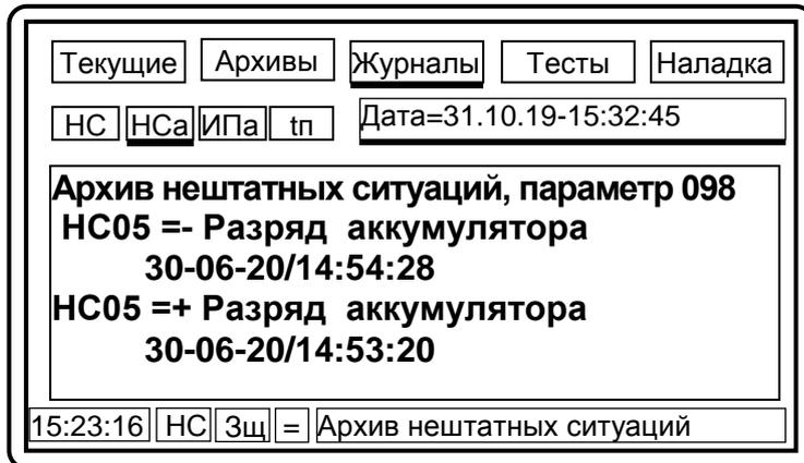
Рисунок 5.8 – Вывод на дисплей информации из архива НСа
