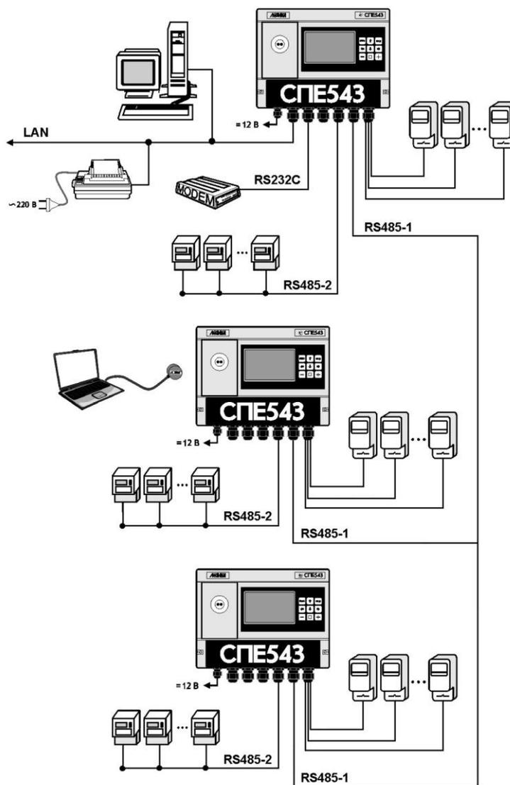
Рисунок 2.1 – Система учета электрической энергии на базе сумматора
