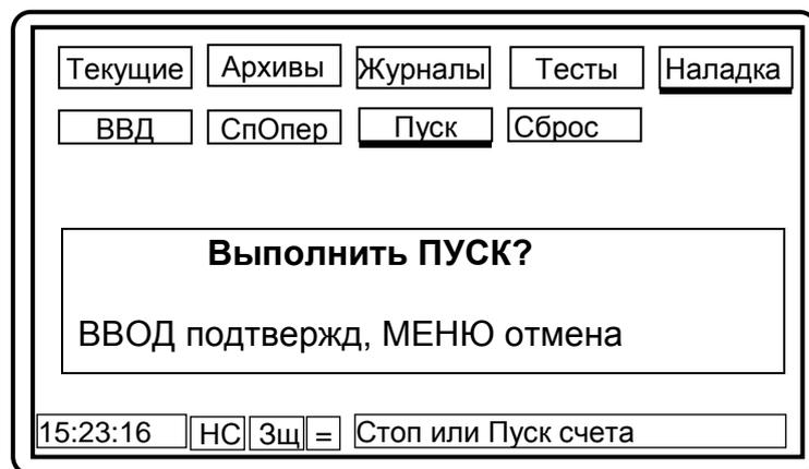
Рисунок 5.24 – Запрос на ПУСК сумматора
