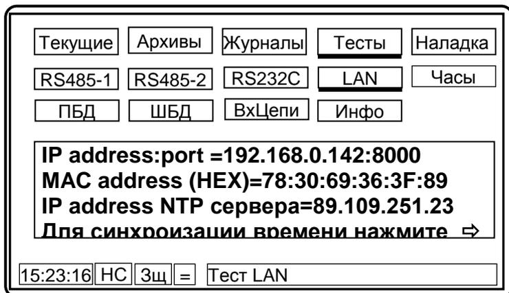
Рисунок 5.12 – Пример вывода на дисплей теста LAN
