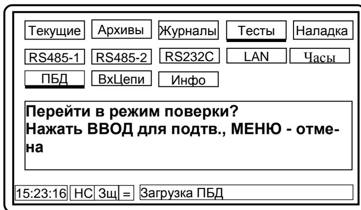
Рисунок 5.14 – Переключение в режим поверки
