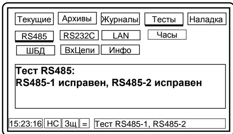
Рисунок 5.11 – Вывод на дисплей результата тестирования RS485
