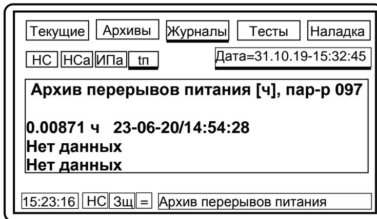
Рисунок 5.10 – Вывод на дисплей информации из архива тп
