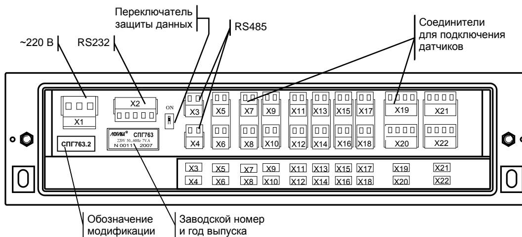
Рисунок 3.2 – Монтажный отсек (крышка снята)
