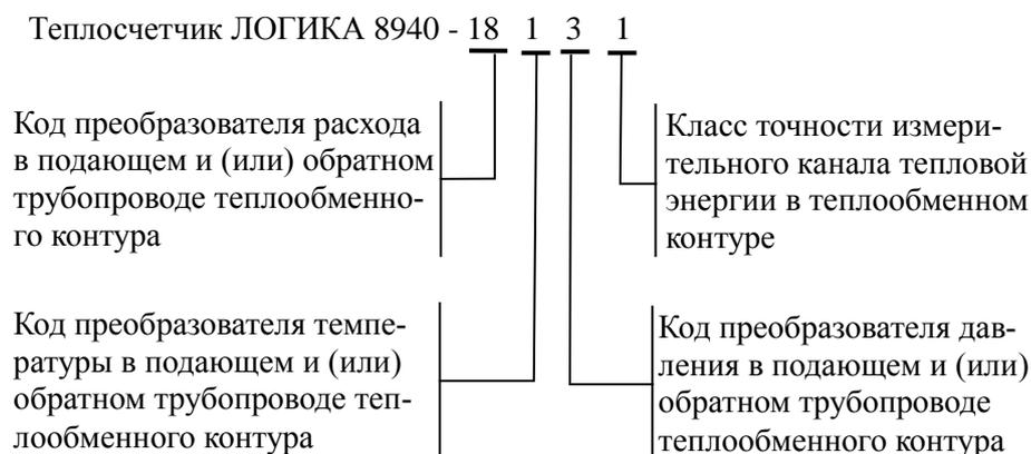
Рисунок 2.1 – Структура обозначения теплосчетчиков
