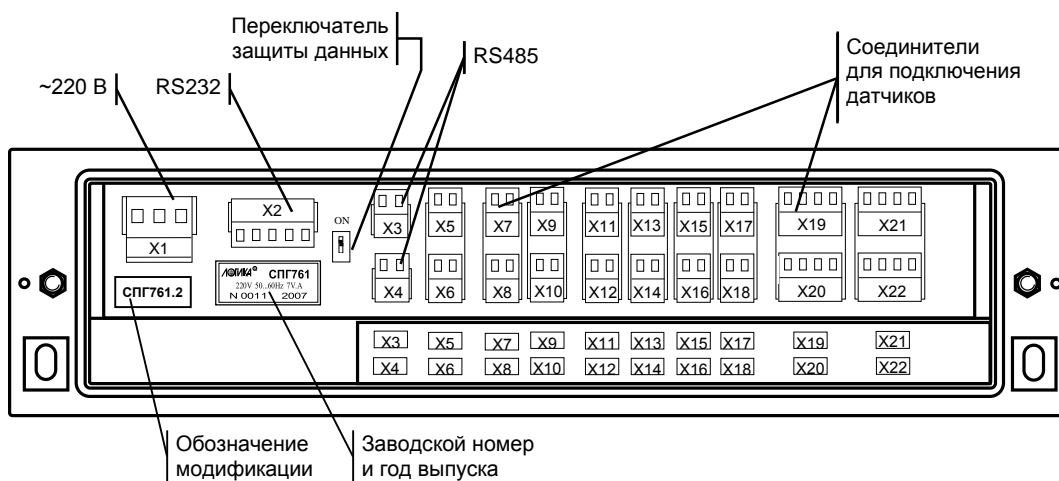
Рисунок 3.2 – Монтажный отсек (крышка снята)
