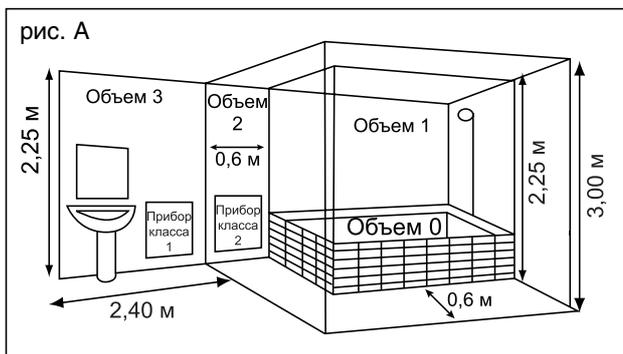
Данный прибор может быть установлен в зонах 2 и 3 при условии, что сеть электропитания будет защищена устройством автоматического отключения со встроенным реле тока утечки с номиналом 30 мА.
