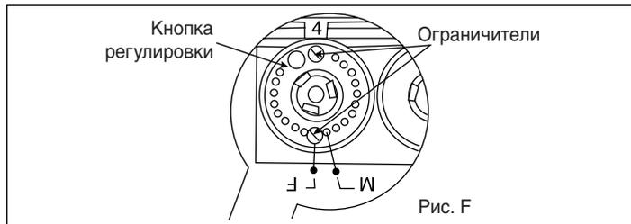
Ручка регулятора температуры оснащена двумя ограничителями, с помощью которых можно фиксировать диск в положении, соответствующем заданной температуре.
