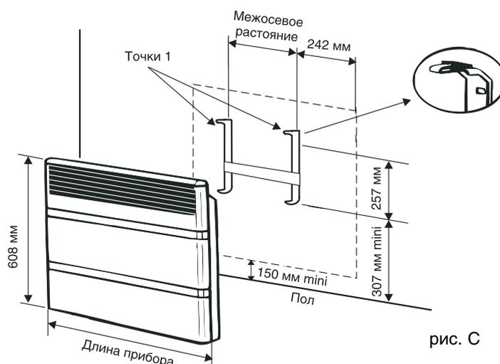
Надавив на две лапки монтажного кронштейна (точки 1, Рис. С) с помощью отвертки, отделите монтажный кронштейн от прибора.
