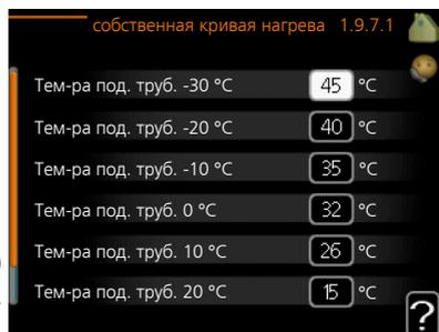
Здесь можно создать собственную кривую нагрева или охлаждения, установив требуемые значения температуры подачи для различных наружных температур.
