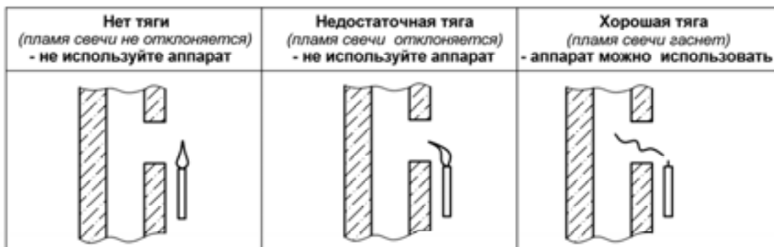
Рисунок 4. Способ проверки тяги в дымоходе
