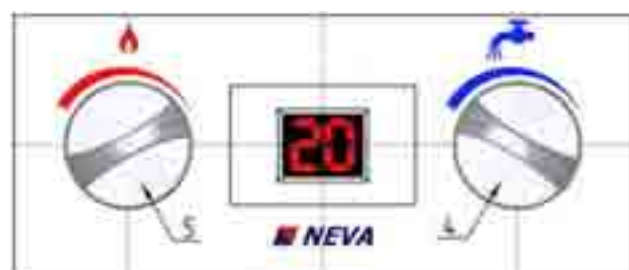
Рисунок 9 Положение ручек перед включением аппарата
