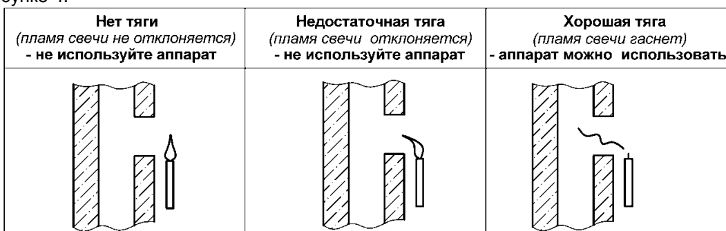
Рис. 4. Способ проверки тяги в дымоходе
