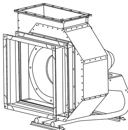
**Рисунок 13.** Монтаж гибкой вставки квадратной с адаптером
