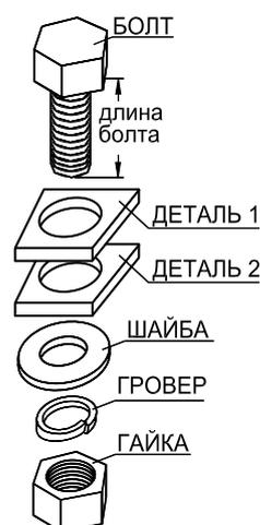
Рисунок 10. Соединение фланцев
