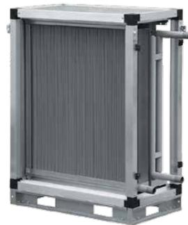
Поверхность теплообмена изготовлена из алюминиевых пластин и проходящих через них в шахматном порядке медных трубок. Трубные коллекторы из стали имеют резьбовые патрубки для обезвоздушивания теплообменника и слива воды. Все секции стандартно оснащены профильным пластиковым каплеуловителем и поддоном с патрубком для сбора и слива конденсата. Возможно оснащение алюминиевым каплеуловителем (исполнение CA1). Теплообменник с поддоном и каплеуловителем расположен
