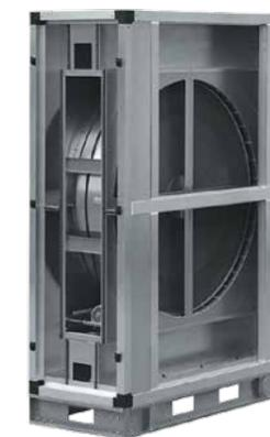
Нагрев холодного приточного воздуха осуществляется за счёт аккумуляции теплоты вытяжного воздуха на поверхности теплообмена с последующей ее отдачей. Поверхность теплообмена образована вращающимся барабаном из волнообразных алюминиевых лент. 3 класса эффективности регенераторов:
