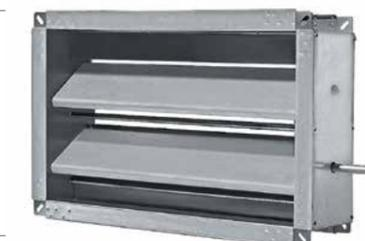
Используется для перекрытия и регулирования потока воздуха с возможностью предварительного прогрева лопаток перед открытием. Корпус заслонки изготовлен из оцинкованного стального листа, а поворотные лопатки из алюминиевого профиля. Трубчатые нагревательные элементы расположены в местах примыкания лопаток и исключают возможность их примерзания друг к другу и к корпусу заслонки. Клеммы подключения ТЭНов выведены в монтажную коробку, которая располагается на боковой поверхности кор-
