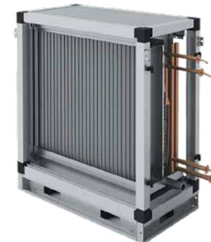
Поверхность теплообмена изготовлена из алюминиевых пластин и проходящих через них в шахматном порядке медных трубок. Все секции стандартно оснащены профильным пластиковым каплеуловителем и поддоном с патрубком для сбора и слива конденсата. Возможно оснащение алюминиевым каплеуловителем (исполнение CA2). Теплообменник с поддоном и каплеуловителем расположен на специальных направляющих, что позволяет легко извлекать его из корпуса.
