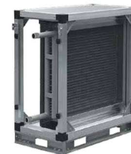
В секции возможны два исполнения: двухрядное и трёхрядное. Предназначены для эксплуатации при максимальном рабочем давлении 1,5 МПа и максимальной рабочей температуре воды 170°C. Поверхность теплообменника изготовлена из алюминиевых пластин и проходящих через них в шахматном порядке медных трубок. Трубные коллекторы из стали имеют резьбовые патрубки для обезвоздушивания теплообменника и слива воды.
