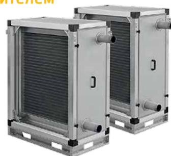
Система рекуперации представляет собой схему передачи теплоты вытяжного воздуха приточному с помощью двух жидкостных теплообменников, находящихся в вытяжной и приточной камерах. КПД рекуперации достигает 50%.
