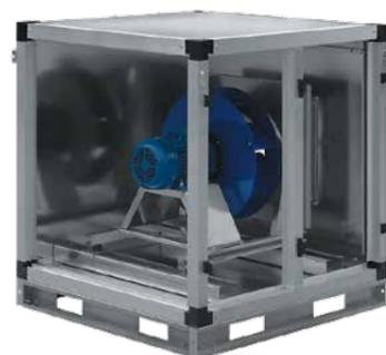
Все вентиляторы имеют свободное рабочее колесо с загнутыми назад лопатками, установленное непосредственно на валу электродвигателя. Имеется исполнение с ЕС-вентиляторами. В ЕС-вентиляторах применяются колеса с назад загнутыми лопатками. ЕС-вентиляторы и рабочие колеса производства Ziehl-Abegg AG Germany обеспечивает высокое качество и надёжность работы вентиляторов.
