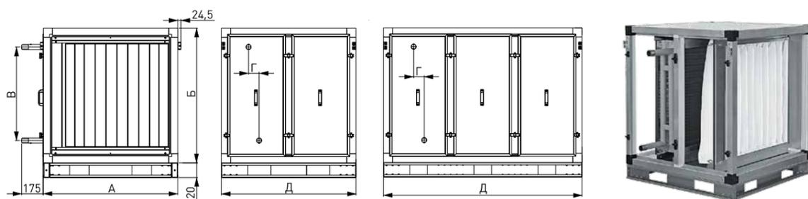
**Секция N5 — фильтрация EU5 + водяной нагрев**
