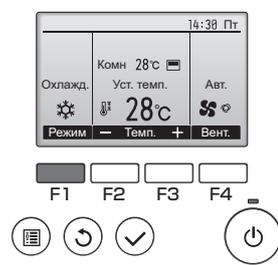
Нажмите кнопку [F1] для перехода между режимами работы в порядке «Охлажд., Сушка, Вент., Авт. и Нагрев». Выберите желаемый режим работы.
