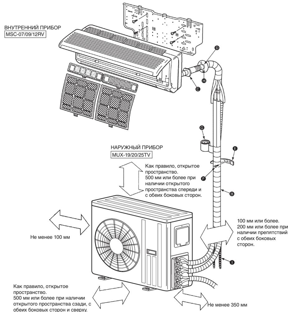
Данная диаграмма предназначена для демонстрации конфигурации дополнительных принадлежностей. Для выполнения реальной установки наружный прибор необходимо повернуть на 180°.
