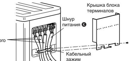
Правильно подсоединив провода соединения внутреннего/наружного приборов и шнур питания к блоку терминалов, не забудьте закрыть блок терминалов крышкой.
