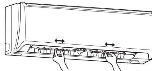
Отрегулируйте положение вертикальной заслонки до начала работы кондиционера. Так как горизонтальная заслонка движется автоматически, она может прищемить Вам пальцы.
