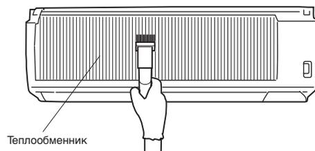
Очистить поверхность теплообменника можно, установив на пылесос щетку из КОМПЛЕКТА БЫСТРОЙ ОЧИСТКИ. Подробные указания по очистке приведены в руководстве к КОМПЛЕКТУ БЫСТРОЙ ОЧИСТКИ.
