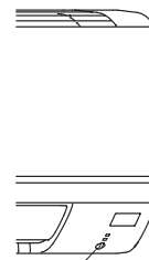
Переключатель аварийного управления (E.O. SW)
