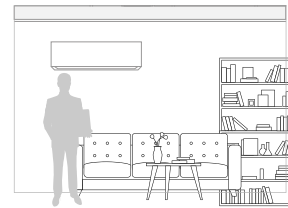
Имеется некоторое расстояние от потолка
