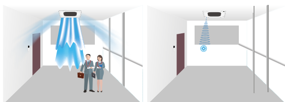
Внутренний блок автоматически включается при обнаружении человека
