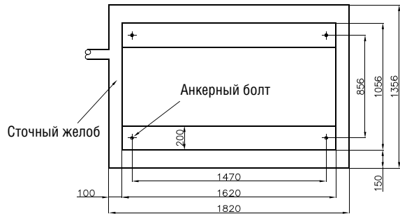
Чертеж, содержащий монтажные размеры модуля Рис. 3-3
