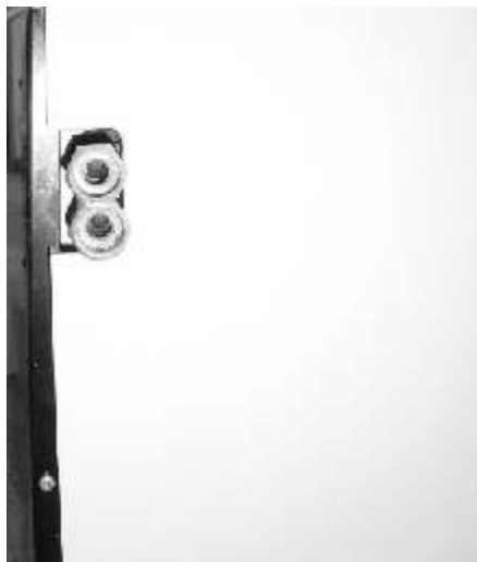
Фото - присоединительная резьба тепловодного вкладыша
