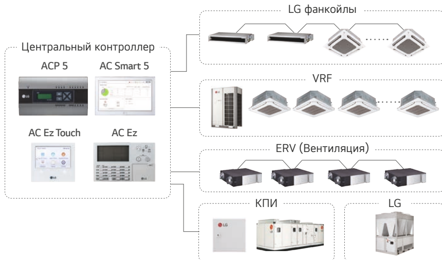
Пример 4. LG фанкойлы + Чиллер (LG или сторонний) > Modbus > BMS.
