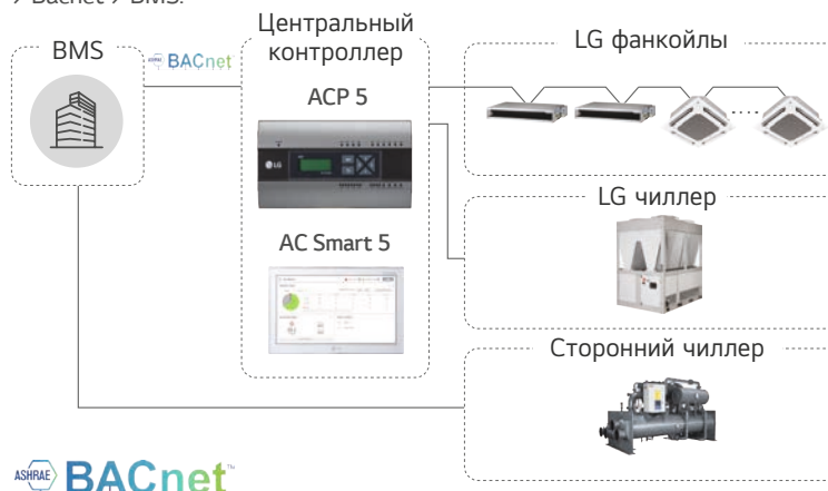
Пример 5. LG фанкойлы + Чиллер (LG или сторонний) > Bacnet > BMS.
