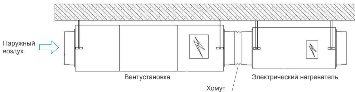
Монтаж электрического нагревателя
