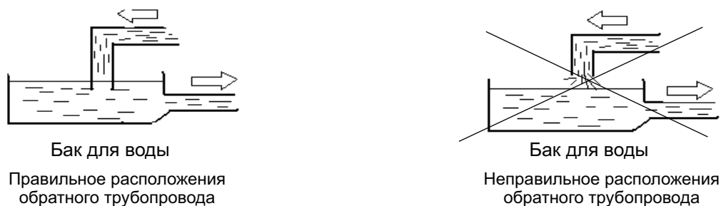
Рис. 3. Расположение обратного трубопровода хладонсителя
