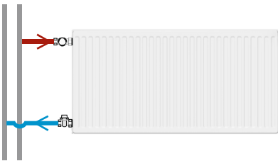
Боковое одностороннее подключение
