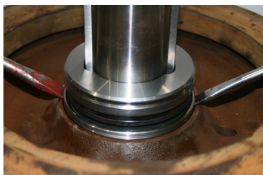
Рис. 10: Извлечение торцевого уплотнения с помощью монтировок 2. Удалить и утилизировать уплотнительную прокладку 400.04.
