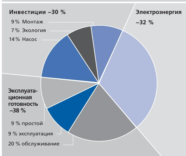
**KSB оптимизирует не только отдельные элементы, но и всю гидравлическую систему в целом**
