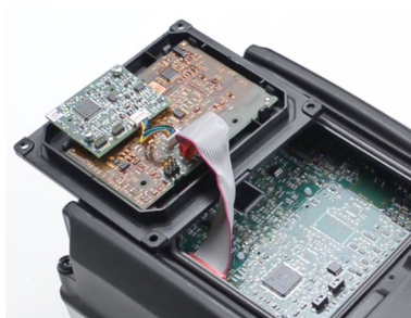
Рис. 41: Установка модуля Bluetooth
