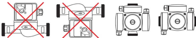
Направление стрелки на корпусе насоса должно соответствовать направлению потока жидкости в трубопроводе. Для монтажа необходимо применять присоединительные гайки и прокладки, которые поставляются отдельно.
