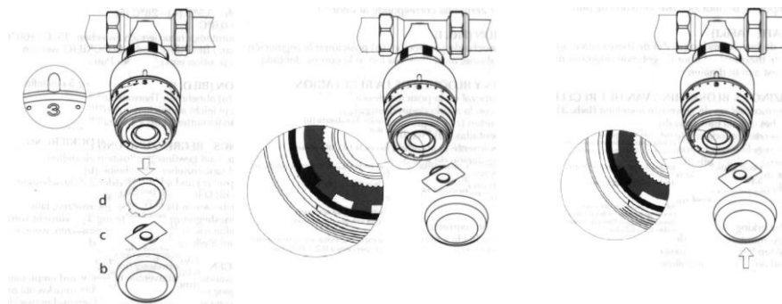
Рис 4.б,в,г Настройка термостатической головки.
