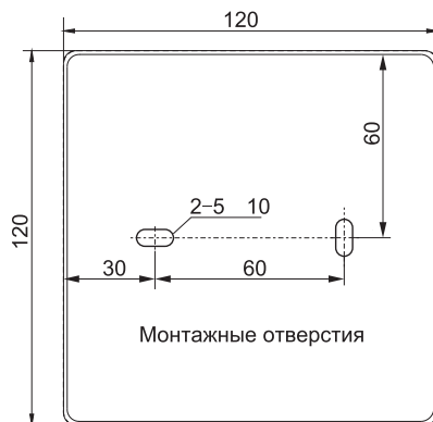
Рисунок 3. Установочные размеры проводного пульта
