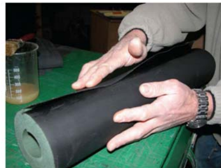
... и приступайте к финальному закрытию шва, аккуратно прижимая нахлест к ответной части покрытия.
